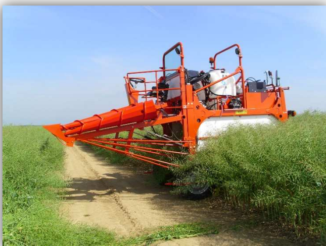
Pointes relevables pour faciliter les manœuvres en bout de champ
