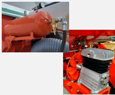
Compresseur Manomètre de contrôle
