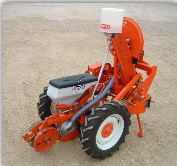
Version « arrêt sur parcelle » semi-automatique avec vanne électrique et motoréducteur
