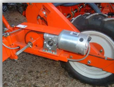
Version « arrêt sur parcelle » semi-automatique avec vanne électrique et motoréducteur
