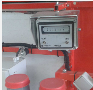
Contrôleur de semis avec deux modes d'utilisation
