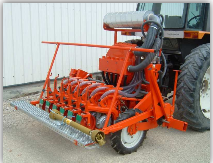
Version « arrêt sur parcelle » semi-automatique avec vanne électrique et motoréducteur
