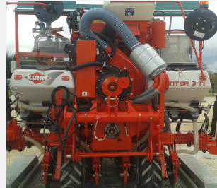
Microgranulateur pneumatique « insecticide, herbicide, anti-limace » Turbine avec silencieux
