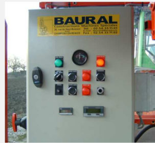
Armoire électronique avec sécurités acoustiques et visuelles
