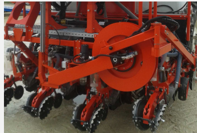
Enrouleur de câble automatique repliable Câbles avec butées de 200 à 800m
