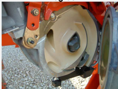
Boîtier de distribution avec chambre de réaspiration intégrée
