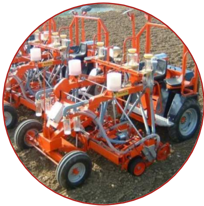
Tête de distribution avec mise à niveau manuelle ou automatique
