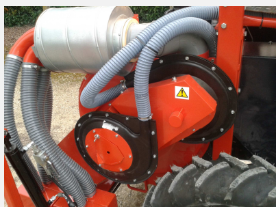
Double turbine pour transport pneumatique
