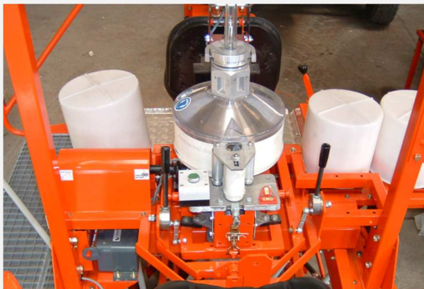
Tête de distribution avec mise à niveau manuelle ou automatique
