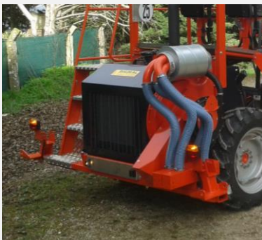
Pneumatic KUHN micro-granulateur
