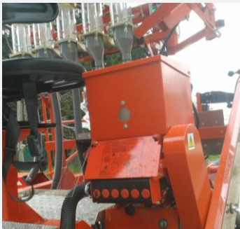
Pneumatic KUHN micro-granulateur
